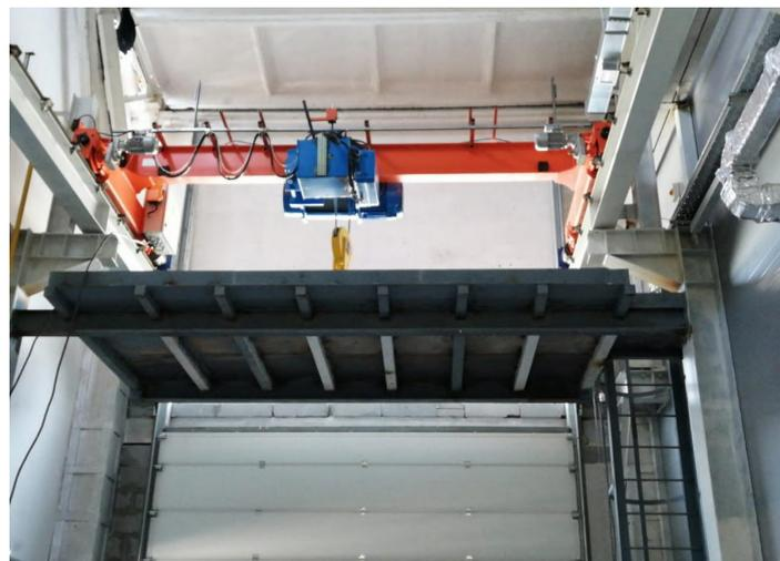
Кран мостовой опорный однобалочный с электроприводом грузоподъемностью 5,0 тонн для предприятия в г. Екатеринбурге.
